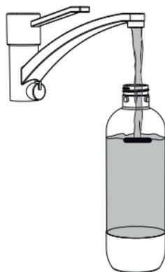
**Important !** Ne gazéifiez jamais autre chose que de l'eau potable, car le sucre ou d'autres additifs pourraient bloquer les soupapes de décharge et présenter un danger.
