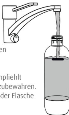
**Wichtig!** Versetzen Sie ausschließlich reines Trinkwasser und niemals andere Flüssigkeiten mit Kohlensäure, da Zucker oder andere Zusätze die Überdruckventile verkleben können. Hierdurch ist ein sicherer Gebrauch des Geräts nicht mehr möglich.
