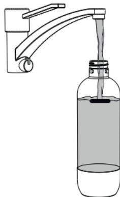
**Důležité upozornění!** Nikdy nesyťte oxidem uhličitým jiné kapaliny než čistou pitnou vodu, protože přídavné látky jako cukr mohou způsobit zaseknutí či uvíznutí přetlakového ventilu, a tím pádem znemožnit bezpečné používání výrobku.
