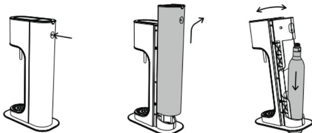
Inclinez la machine à eau gazeuse vers l'avant et insérez la cartouche de gaz dans l'ouverture située à la base de la machine de manière à ce que la cartouche repose sur le plan de travail. Inclinez doucement la machine à eau gazeuse vers l'arrière de façon à ce que la partie supérieure de la machine repose sur le col fileté de la cartouche.
