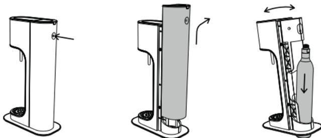
Наклонете машината за газирана вода напред и поставете газовата бутилка през отвора в дъното на машината, така че бутилката да застане на работната повърхност. Внимателно наклонете машината за газирана вода назад, така че горната част на машината да опира в резбованото гърлото на газовата бутилка.
