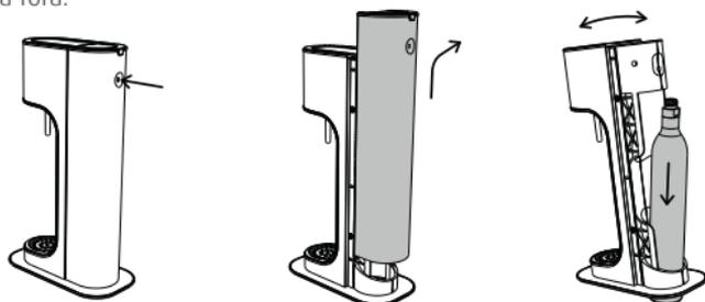
Incline a máquina de gaseificação de água para a frente e introduza o cilindro de gás através da abertura no fundo da máquina de modo a que o cilindro fique assente sobre a superfície de trabalho. Incline suavemente a máquina de gaseificação de água para trás de modo a que a parte superior da máquina fique encostada ao gargalo roscado do cilindro.
