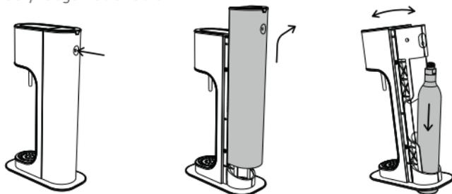
Incline la máquina de agua con gas hacia delante e introduzca la bombona de gas a través de la abertura de la parte inferior de la máquina, de modo que la bombona quede sobre la superficie de trabajo. Incline suavemente la máquina de agua con gas hacia atrás de modo que la parte superior de la máquina se apoye en el cuello roscado del cilindro.
