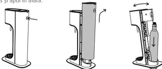
Înclinați aparatul de preparat apă carbogazoasă în față și introduceți butelia de gaz prin deschizătura de la fundul aparatului, astfel încât butelia să stea pe suprafața de lucru. Aplecați ușor înapoi aparatul de preparat apă carbogazoasă astfel încât partea superioară a acestuia să se reazeme pe gâtul filetat al buteliei.
