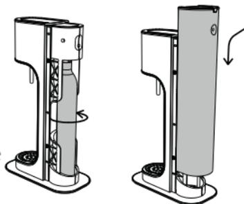
Faites glisser la partie arrière dans ses rainures de guidage et poussez-la vers le bas jusqu'à ce que le mécanisme de verrouillage s'enclenche.
