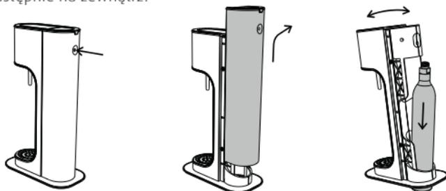
Przechyl saturator do wody gazowanej do przodu i włóż butlę z gazem przez otwór w dolnej części urządzenia, tak aby butla została ustawiona na powierzchni roboczej. Delikatnie odchyl saturator do wody gazowanej do tyłu, by górna część urządzenia oparła się o gwintowaną szyjkę cylindra.
