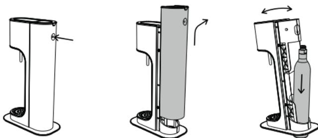
Nagnite aparat za gaziranu vodu prema naprijed i umetnite bocu s plinom kroz otvor na donjem dijelu aparata tako da boca stoji na radnoj površini. Nježno nagnite aparat za gaziranu vodu prema natrag tako da se gornji dio aparata nasloni na vrat boce koji ima navoj.
