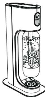
V případě potřeby můžete přidat více plynu tak, že jednou nebo dvakrát krátce znovu stisknete tlačítko. Uvolněte tlačítko a počkejte, dokud neuslyšíte další syčení, jak je vypouštěn přebytečný tlak a lahev s vodou je odvzdušněna.
