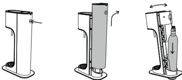
Нахиліть апарат уперед та вставте газовий балон в отвір у нижній частині апарата так, щоб поставити газовий балон на робочу поверхню. Обережно нахиліть апарат назад так, щоб його верхня частина спіралася на різьбову шийку газового балона.
