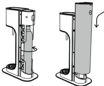
Deslice nuevamente la sección posterior en sus ranuras de guía y empujela hacia abajo hasta que el mecanismo de bloqueo vuelva a encajar en su sitio.
