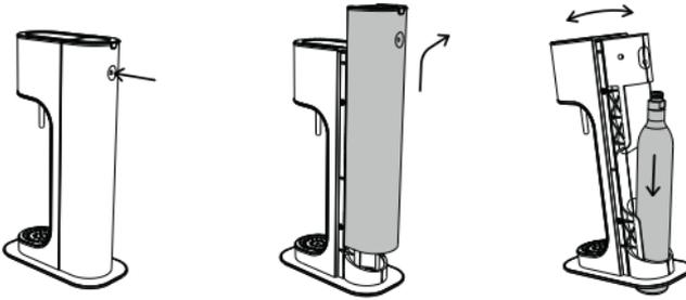
إحّن آلة صنع المياه الغازية نحو الأمام وأدخِل أسطوانة الغاز في الفتحة الموجودة في قعر الآلة، بحيث تصبح الأسطوانة مستندةً إلى سطح الطاولة. إحّن آلة صنع المياه الغازية بلفظٍ إلى الخلف بحيث يستند الجزء العلوي للآلة إلى العنق المُحرز للأسطوانة.
