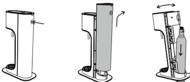
Inclinare il gasatore d'acqua in avanti e inserire la bombola del gas attraverso l'apertura nella parte inferiore della macchina in modo che la bombola si trovi in posizione verticale sulla superficie di lavoro. Inclinare delicatamente il gasatore d'acqua all'indietro in modo che la parte superiore della macchina si appoggi al collo filettato della bombola.
