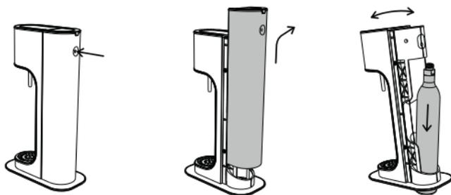
Kippen Sie den Wassersprudler nach vorn und setzen Sie den Gaszylinder durch die Öffnung am Boden des Geräts ein, sodass der Zylinder auf der Arbeitsfläche steht. Kippen Sie den Wassersprudler vorsichtig nach hinten, sodass der obere Teil des Geräts gegen das Gewinde am Zylinderhals gelehnt ist.
