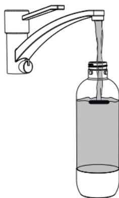
**Важно!** Газируйте только чистую питьевую воду. Сахар и прочие добавки, содержащиеся в иных жидкостях, могут привести к застреванию предохранительных клапанов давления, что сделает использование сифона небезопасным.
