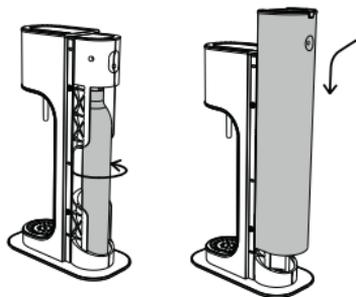
Führen Sie die rückseitige Abdeckung wieder in die Führungsnut ein und drücken Sie sie herunter, bis die Verriegelung hörbar einrastet.
