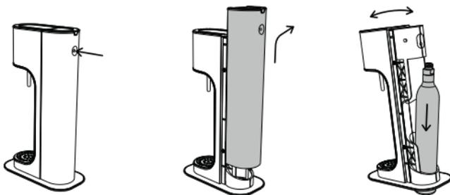
Kantel de bruiswatermaker naar voren en steek de gascilinder door de opening in de bodem van het apparaat, zodat de fles op het werkblad staat. Kantel de bruiswatermaker voorzichtig naar achteren, zodat het bovenste deel van het apparaat tegen de schroefdraadnek van de cilinder rust.
