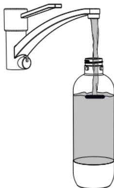
**Importante!** Nunca deverá gaseificar outra solução que não seja água potável pura, pois o açúcar ou outros aditivos podem fazer com que as válvulas de descompressão fiquem coladas, tornando a máquina insegura para ser utilizada.
