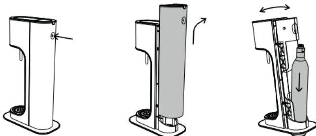
Наклоните сифон для газирования воды вперед и вставьте газовый баллон через отверстие в его нижней части, так, чтобы баллон опирался на твердую поверхность. Аккуратно наклоните обратно сифон для газирования воды, так, чтобы его верхняя часть находилась прямо над резьбовой частью баллона.
